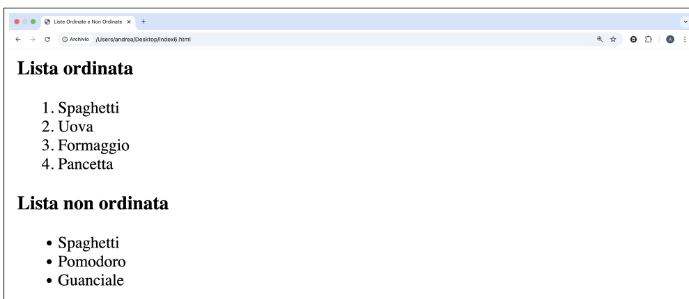
Figura 1.6: Esempio di un codice HTML con liste e relativa visualizzazione nel browser
