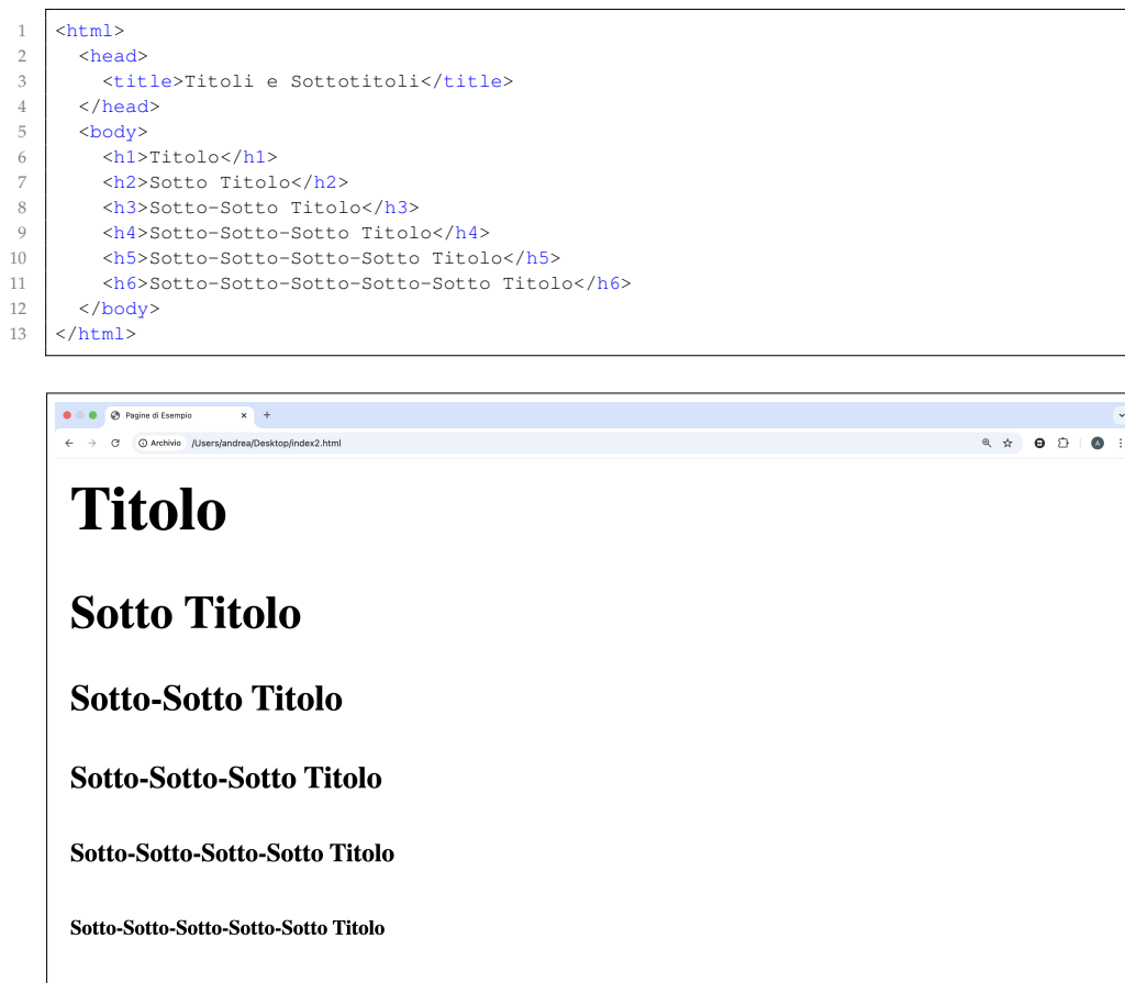
Figura 1.2: Esempio di un codice HTML con titoli e sottotitoli e relativa visualizzazione nel browser
