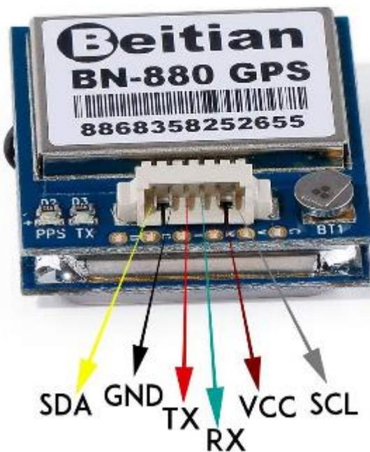
Il modulo in oggetto oltre ad avere integrato il GPS, oggetto dell'esercitazione, ha anche integrato una bussola (compass) HMC5883l comunicante tramite il bus/protocollo I2C.
